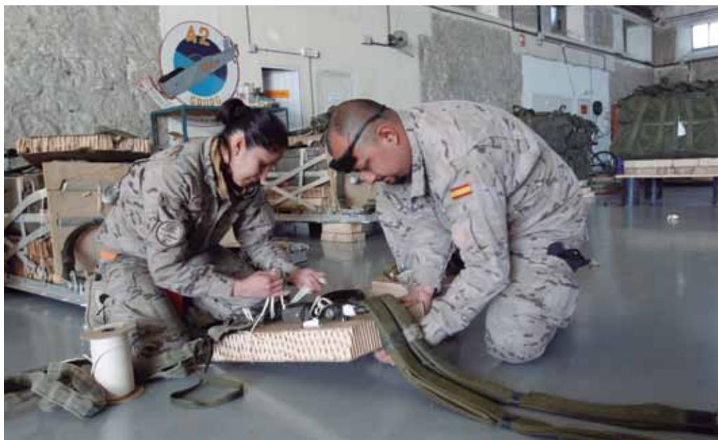
Dos especialistas del Escuadrón de Apoyo al Despliegue Aéreo colocan el paracaídas como último paso de la preparación del lanzamiento de una plataforma metálica.
