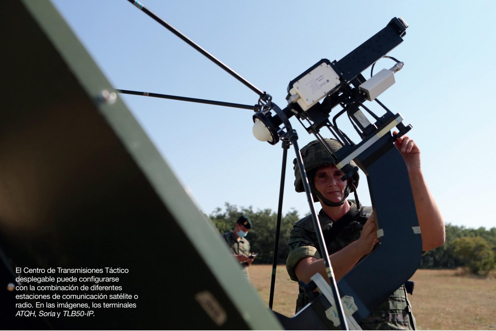
El Centro de Transmisiones Táctico desplegable puede configurarse con la combinación de diferentes estaciones de comunicación satélite o radio. En las imágenes, los terminales ATQH, Soria y TLB50-IP.
