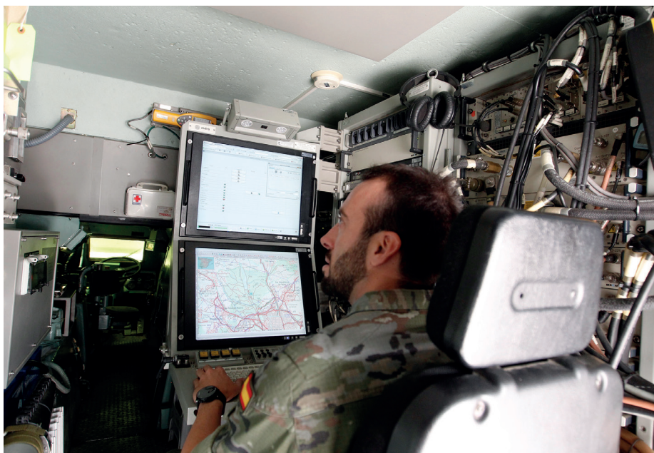
El equipamiento electrónico con el que opera la unidad puede interceptar comunicaciones de radio, imagen o data link .
