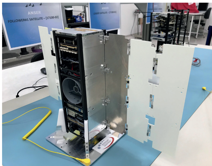
El despliegue de las solapas permite modular la resistencia aerodinámica para realizar maniobras de acercamiento y separación entre los satélites.
